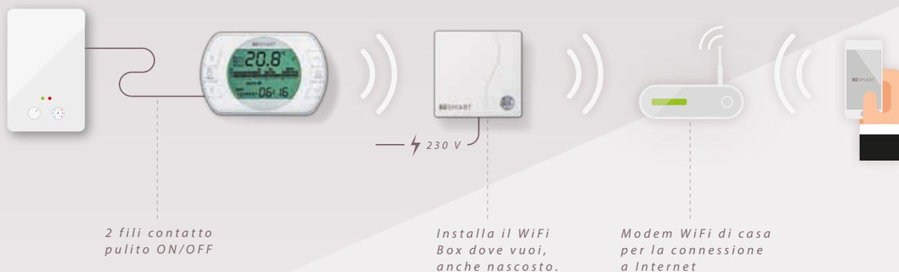
**NB:** Nella sostituzione, nel caso in cui sui vecchi termostati siano presenti più di 2 cavi, vanno individuati e collegati i soli cavi di acceso/spento. Il termostato BeSMART non necessita alimentazione da rete elettrica, in quanto funziona con batterie proprie.
